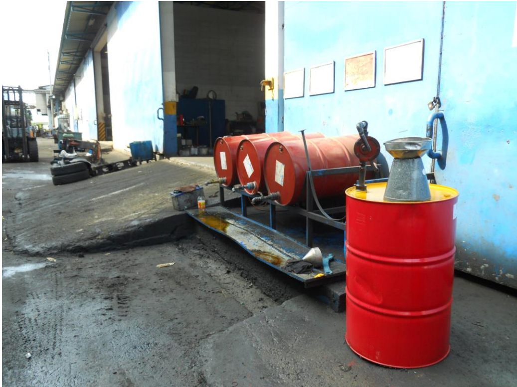
ภาพที่ ค-3 บริเวณซ่อมบำรุงมีคาน้ำมันและมีร่องรอยการหกรั่วไหลของน้ำมันทั่วไป
