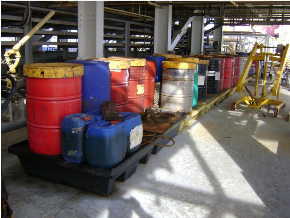
ภาพที่ ค-16 พบว่ามีการจัดวางถังสารเคมีอยู่บนถาดรองแต่บางถังไม่ได้รับการปิดฝา
