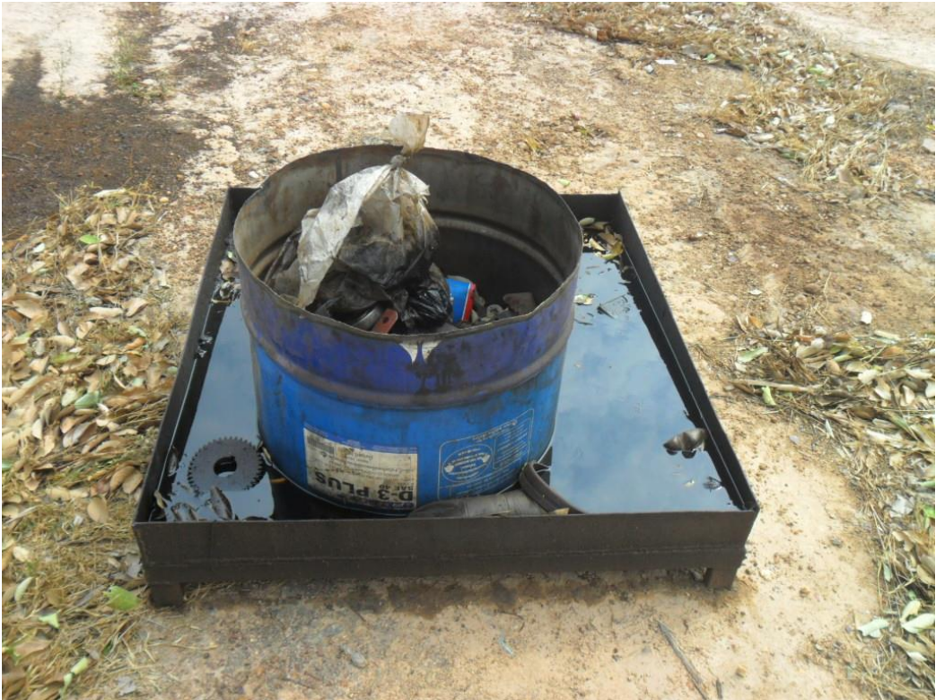
ภาพที่ ค-8 มีการวางถาดรองน้ำมันเครื่องใช้แล้วบริเวณกลางแจ้ง
