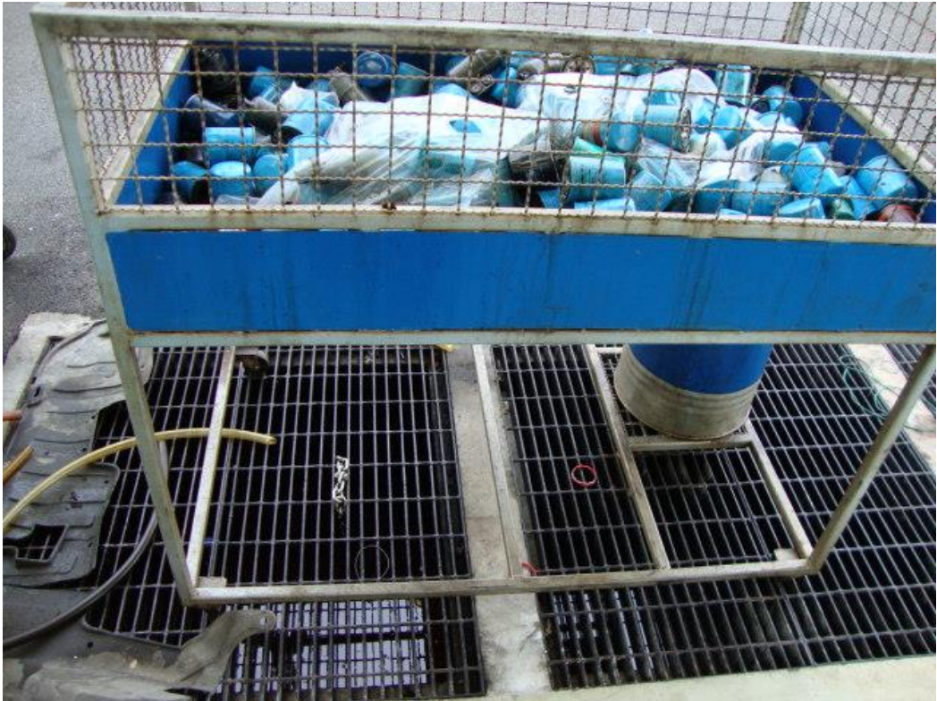
ภาพที่ ค-10 กรองน้ำมันเครื่องวางอยู่บนรางระบายน้ำและมีน้ำมันอยู่ใน รางระบายน้ำด้วย
