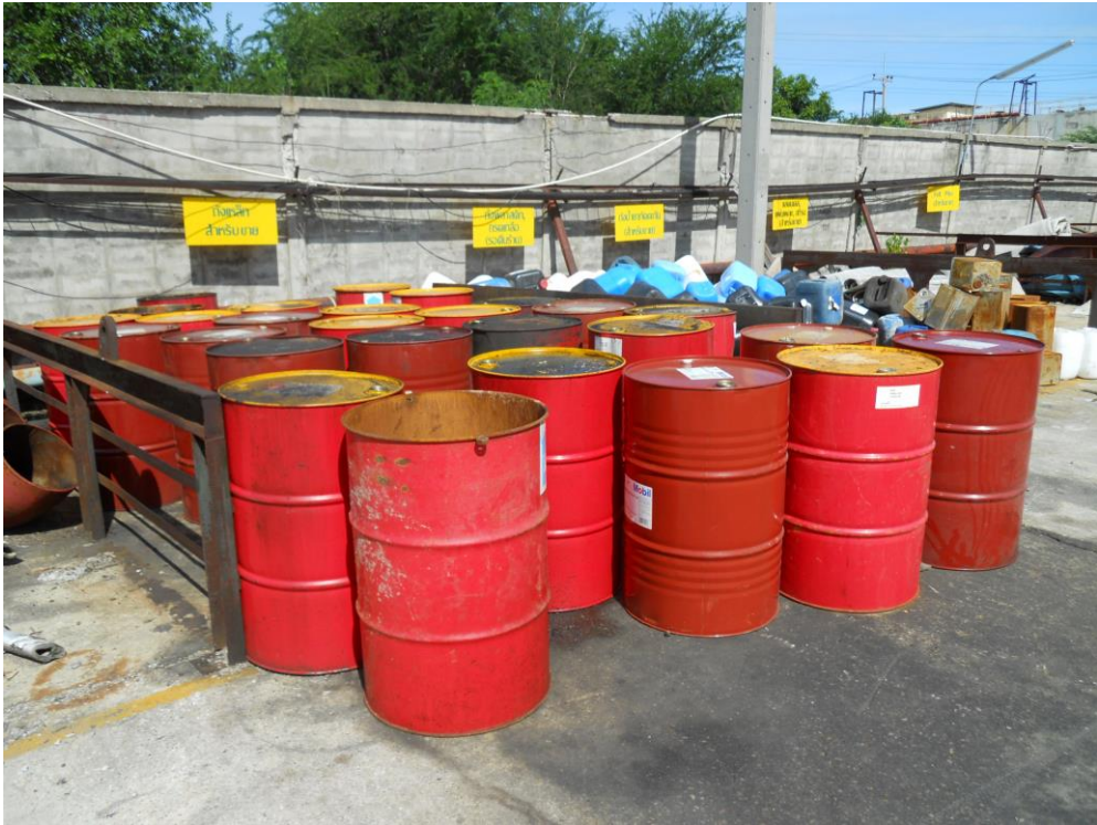
ภาพที่ ค-1 ถังใส่น้ำมันและสารเคมีเปิดทิ้งไว้ บางถังก็ไม่ได้ปิดฝา
